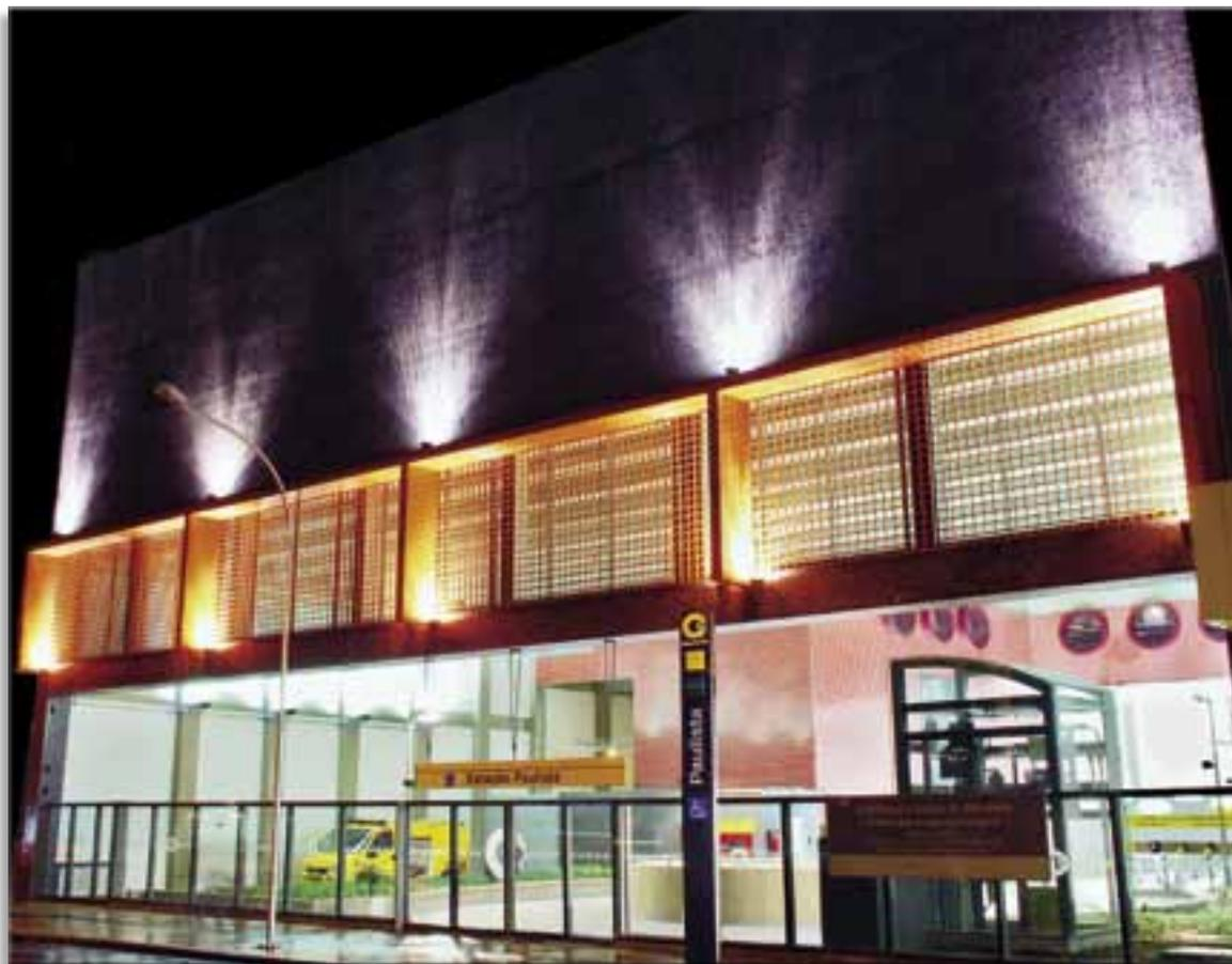
Projetores com 30° de abertura com lâmpadas de vapor metálico de 150W iluminam a fachada da estação.
